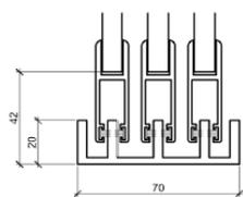
Führungsschiene mit Wetterbank in mm
